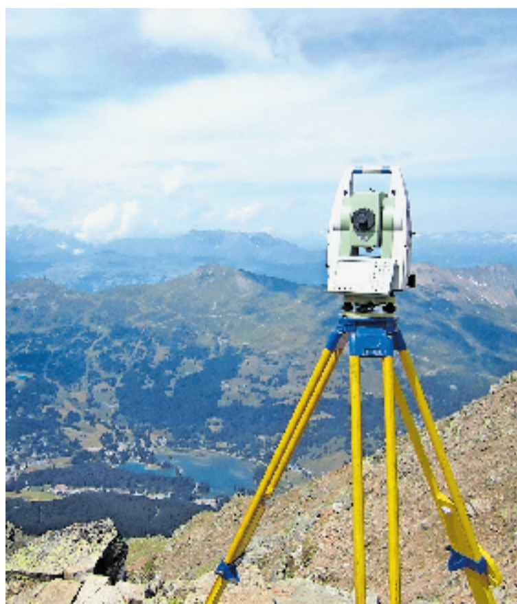
Eine Tachymeter-Totalstation im Einsatz. Foto: Grünenfelder und Partner AG
